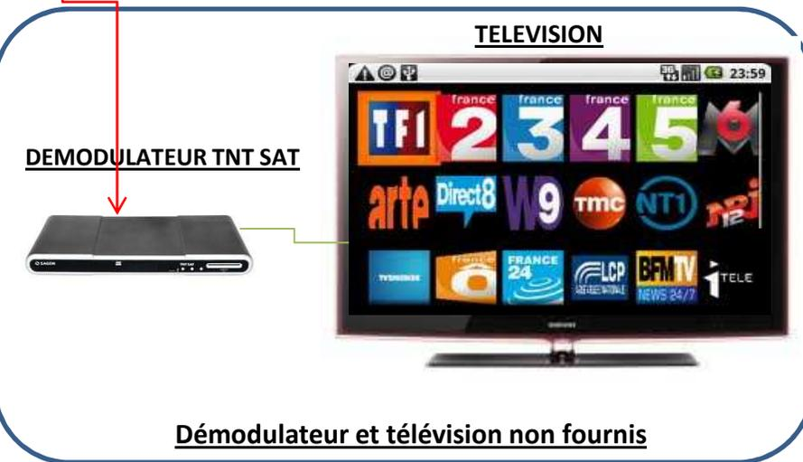
**Astuce:** afin de pouvoir connecter Deux démodulateurs il faut un démodulateur Avec une entrée et une sortie signal.
